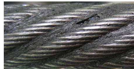
Lina lewoskrętna – rotacja przeciwna do ruchu wskazówek zegara
