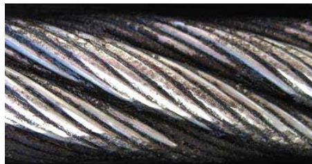
Lina prawoskrętna – rotacja zgodna z ruchem wskazówek zegara
